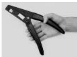
コンタクトを挿入する前に、ハンドルを開放状態にします。未開放のままではコンタクトは挿入出来ません。ハンドルを一杯まで締め付けてから離すと、自動的に開放されます。
