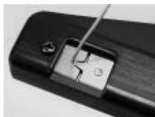
電線がコンタクトから抜け出さないように軽く押し付けながらハンドルを徐々に握り締め、ラチェットが外れるまで締め付けます。この状態で圧着結線は完了です。
