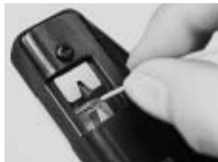
コンタクト圧着バレル内に、電線をコンタクトケーブルストッパに突き当たるまで挿入します。この時ストッパに強く当てすぎますと、ケーブルが曲がったり、捻じれたりしますので注意して下さい。尚、束線が乱れているものは、予め軽く捻って修正しておいて下さい。
