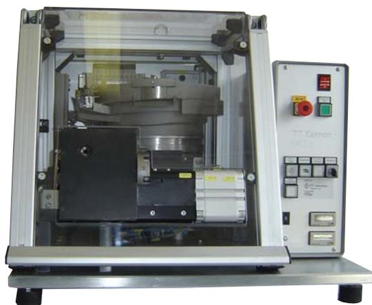
機械によるコンタクトは、キャノン半自動圧着機器 HACS-5を用いて、素早く能率的に端子を付けることができます。
